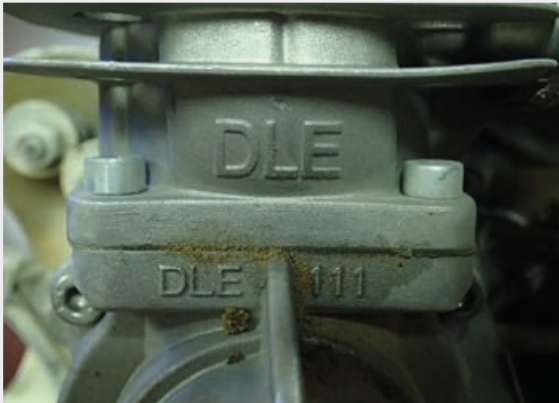
الشكل 5 و6: محرك «دي إل إي 111» من الطائرة بدون طيار التي استُخدمت في هجوم مأرب، أكتوبر 2016.
