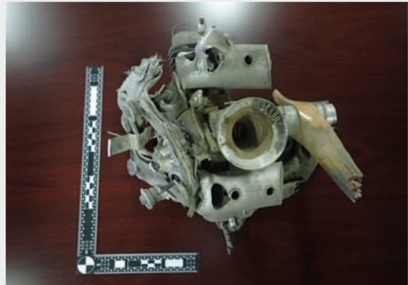
الشكل 5 و6: محرك «دي إل إي 111» من الطائرة بدون طيار التي استُخدمت في هجوم مأرب، أكتوبر 2016.
